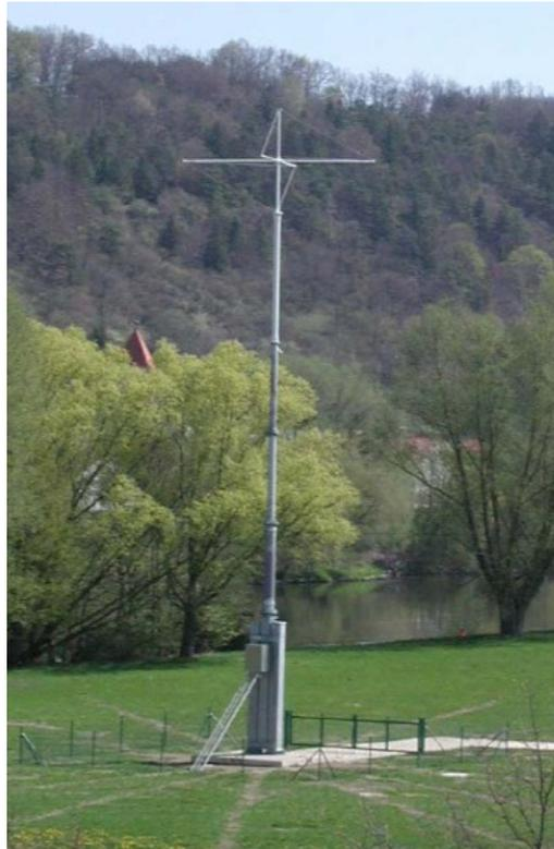
Abb. 11: Bild eines BEACON Korrektursenders
